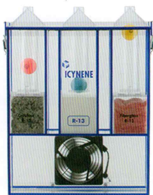
※空気の透過を示す実験 左からセルローズ、アイシネン、 グラスウール
